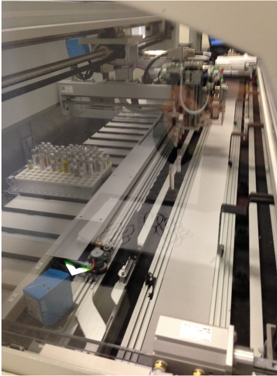
Module réfrigéré robotisé de la chaîne d'automatisation du laboratoire serveur de l'Hôtel-Dieu de Lévis.
