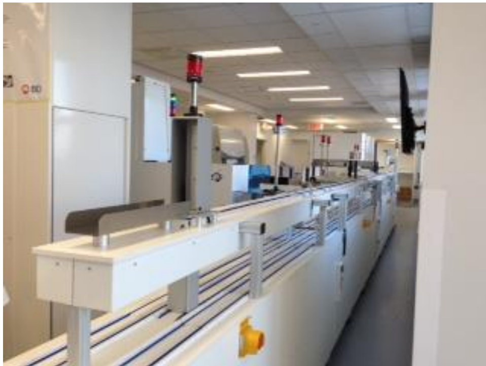
La chaîne de microbiologie Total lab automation (TLA) de Kiestra.
