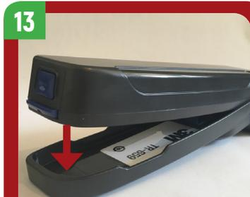
13 Installer la batterie dans l'adaptateur jusqu'à ce qu'elle s'enclenche.
